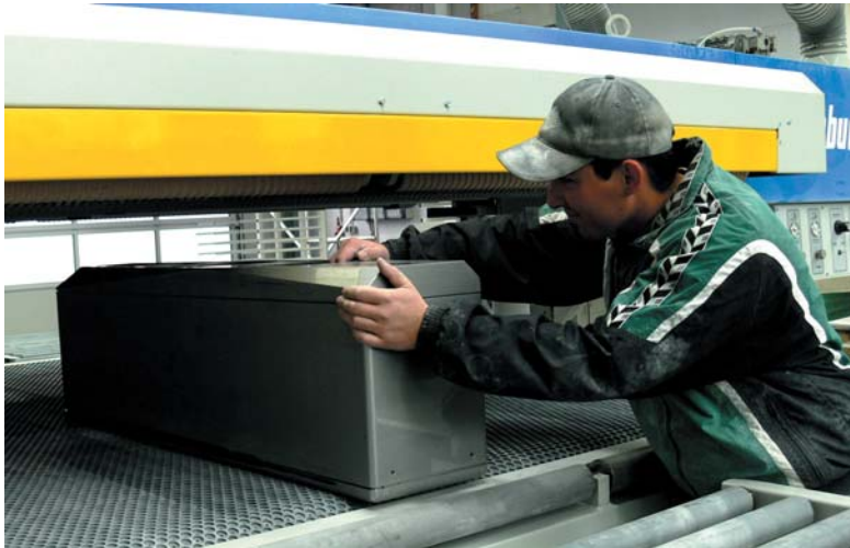
Selbst ganze Korpus-Elemente nimmt die spezielle Flächenschleifmaschine auf. Fotos: Rüter
