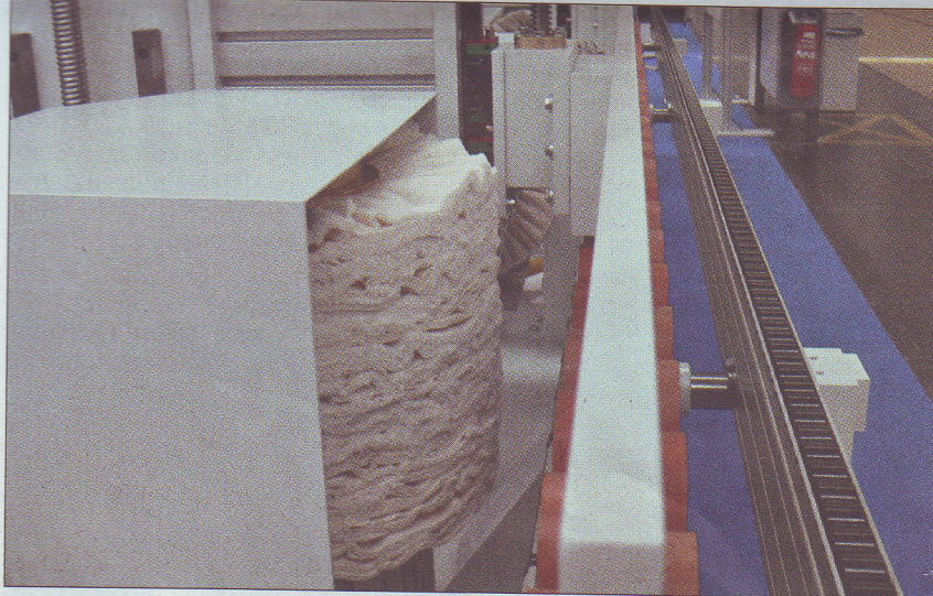
Tagliabue zeigten u. a. Aggregate für das Kantenschwabbeln, wie sie beispielsweise in Kombimaschinen Anwendung finden.
