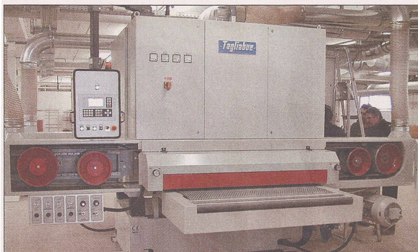
Für das Vorbereiten von Hochglanzoberflächen bietet Tagliabue die auf der "Ligna" gezeigte Schleifmaschinen „TAG TT/3“ an.
