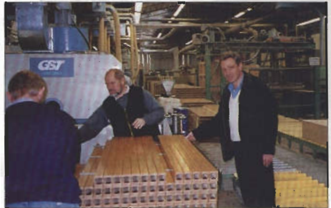
Blick auf um- mantelte und lackierte Furnier- bekleidungssele- mente
