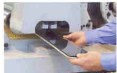
Sostituzione rapida lamina con feltro Quick substitution lamina with felt Schneller Wechsel der Glas- und Schleifbohle
