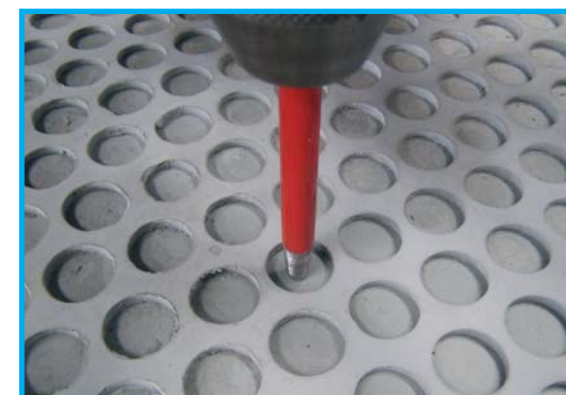
Tappeti forati per ogni esigenza di depressione Holed transport belts Perforierte Transportbänder
