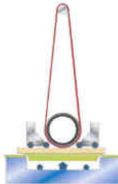
Piano flottante temporizzato per la levigatura di pannelli con spessori diversi Floating table for the sanding of panel with different thicknesses Zeitgesteuertes "Fliehkraft-System" für den Ausgleich von Stärkeunterschieden bei Roh- und Lockschliff
