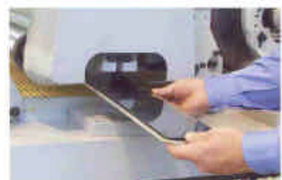
Sostituzione rapida lamina con feltro Quick substitution lamina with felt Schneller Wechsel der Gleit- und Schleifbohle
