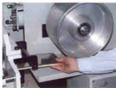
Sostituzione rapida lamina con feltro Quick substitution lamina with felt Schneller Wechsel der Gleit- und Schleifbohle
