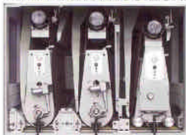
Dispositivo di intervento a tempo Time intervention device Einsatzgesteuerter Schleifschuh
